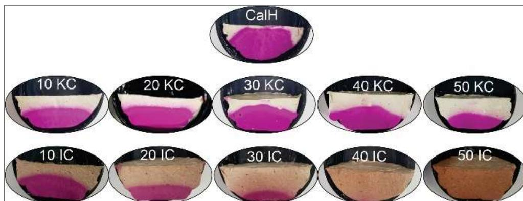
**Figura 22.** Perfil de carbonatación con fenolftaleína en pastas 28 días cámara húmeda + 1 mes carbonatación (ii).
